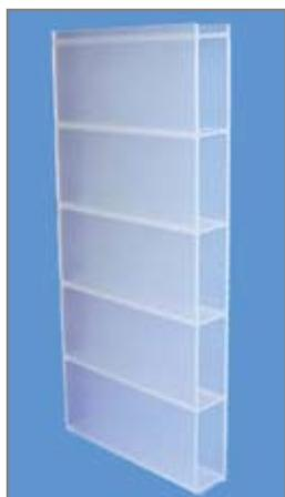
Материал **HEATSTOP** представляет собой двухслойный сотовый лист, отражающий инфракрасное излучение, изготовленный из ударно-модифицированного полиметилметакрилата (ПММА). На сотовом листе покрытие HEATSTOP нанесено не на саму поверхность, а равномерно распределено и интегрировано в объем листа.
