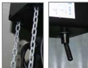
Встроенный расцепитель и ручной цепной редуктор
